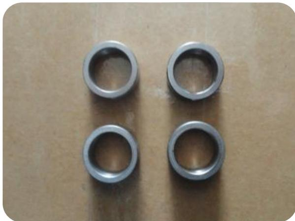
密封轴套是为了保护转子轴在高速运转时，不被无油密封划伤，其磨损后同样会导致润滑油进入缸体，污染真空，极限压力不良等。磨损过度的需要进行更换。
