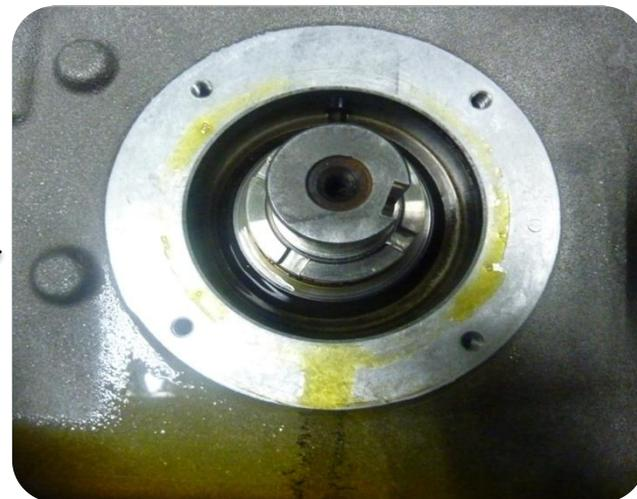
机械密封是有一定寿命的，因为机械密封在运转时，动环和静环都会产生磨损，超过使用寿命的机械密封会导致腔体漏气，真空泵油会漏到腔体内部和电机法兰处，从而污染真空室等不良情况。根据机械密封的老化磨损情况判断是否需要更换，从而防止上述不良情况的发生。
