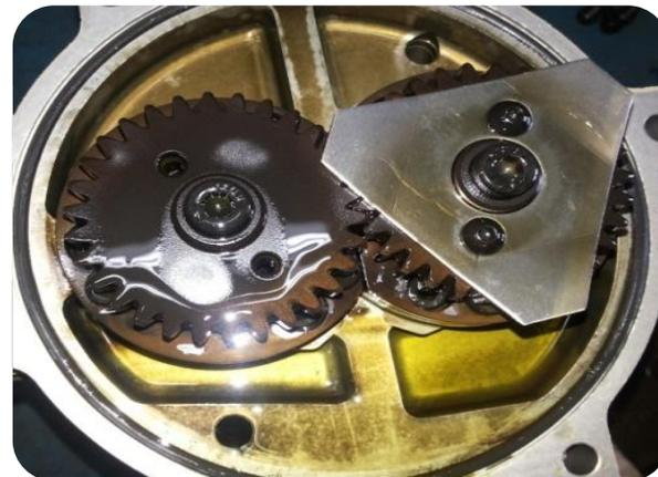
齿轮作为泵的传动件，其状态直接影响泵在高速运转的平稳性。齿轮的间隙和跳动值会随着泵的使用而产生变化，使用一段时间后，如果超出适用范围，导致泵性能下降。维护保养时，可以测量齿轮的间隙，根据实际值，进行调整，使齿轮达到最佳的使用状态。
