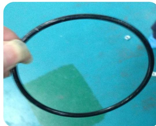
O形圈是橡胶材料，作用是密封，会随着使用而慢慢老化，老化的O形圈会引起真空系统漏气，极限抽不下去的不良情况。对泵内部老化O形圈进行更换，可以预防上述不良情况的发生。
