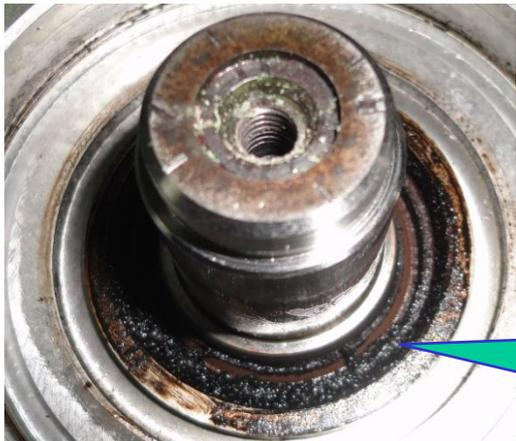
无油密封是保证罗茨泵缸体内无油的关键，老化或磨损的无油密封会导致润滑油进入缸体，污染真空，极限压力不良等。老化的或者破损的需要进行更换。
