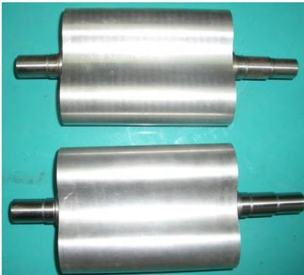
转子磨损会造成震动大和异常音，影响泵的抽气速率和性能
